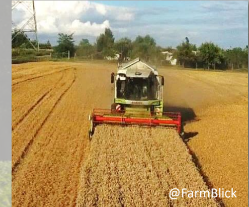
Mähdrescher mit Lenksystem und Ertragskartierung
