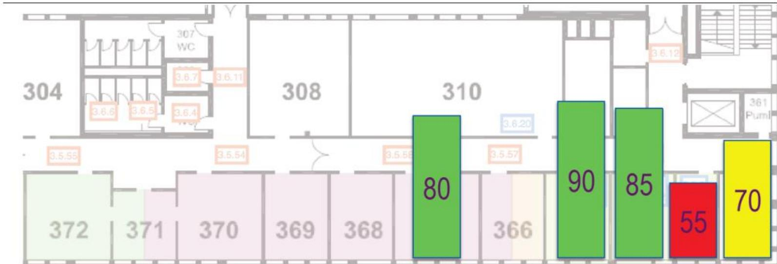
*Scores durch Zuordnung der Waschraum-Verweildauer zu Zielen oder Ursprung der Sensorevents.*
